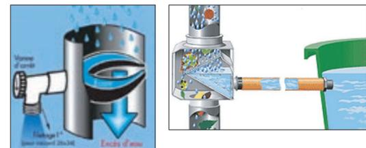
Un réservoir auquel il est conseillé d'adjoindre un système de trop-plein dont la surverse sera de préférence infiltrée dans le sous-sol proche. Ce réservoir nécessite un robinet à clef.
