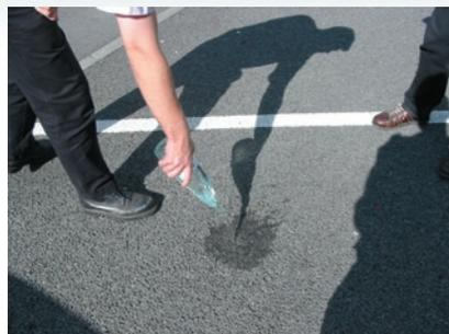
Infiltration des eaux pluviales sur les enrobés poreux.
